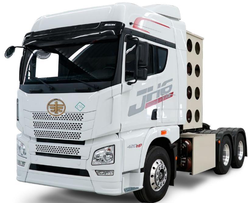
**Equipamiento:** Frenos Wabco (Neumáticos-Aire) Discos delanteros y traseros, Sistema Antibloqueo de frenos ABS Intarder 5 pasos, Freno de escape, Capacidad Eje Delantero: 7,000 Kgs. Capacidad Eje Trasero: 26,000 Kgs. Paso Diferencial: 3.71 / 4.11 / 4.44. Servicio cada 20,000 kms. Garantía: 2 años ó 350,000 Kms. Cabina con aire acondicionado, Cristales Eléctricos, Estéreo AM/FM/USB
